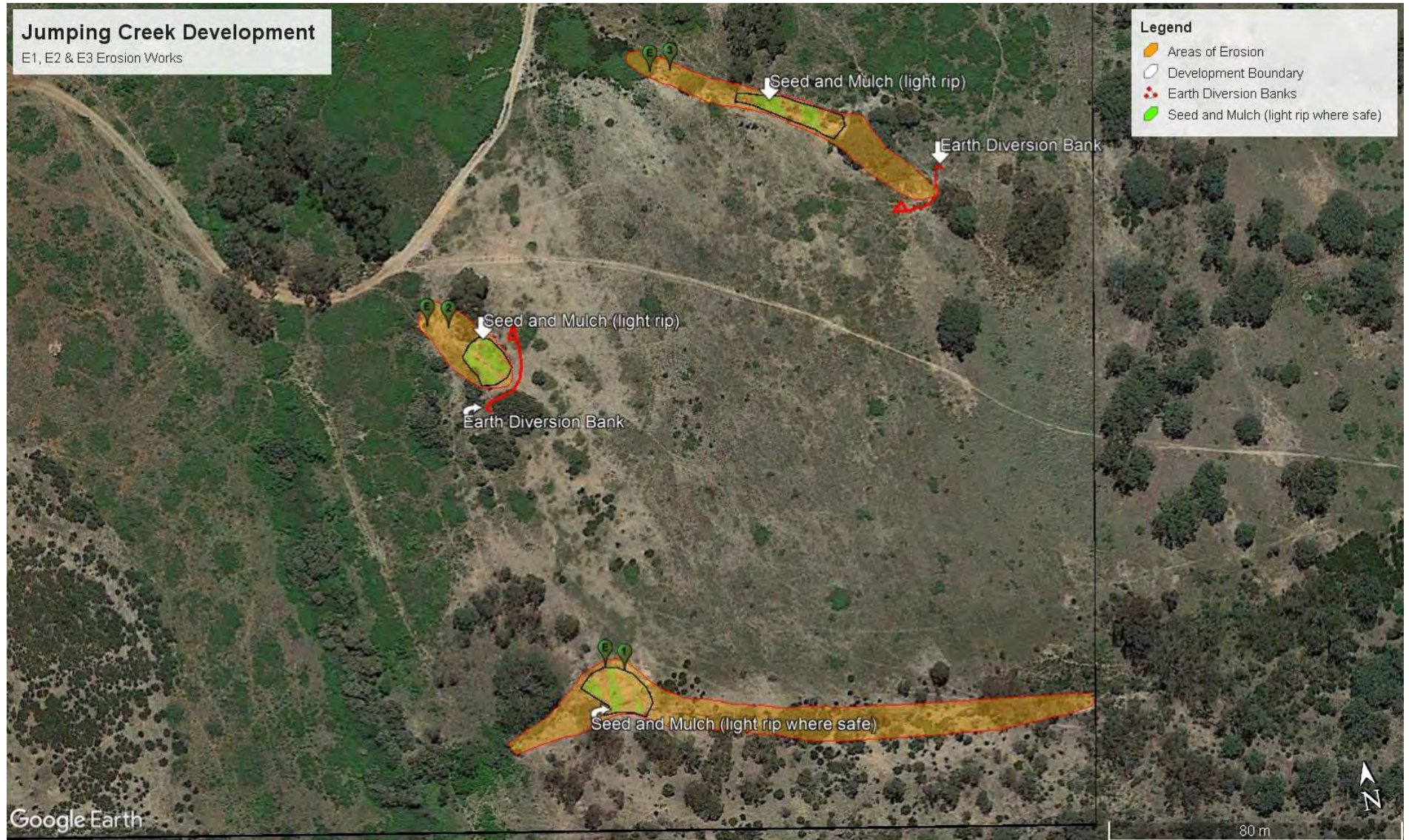
Figure 4: E1, E2 and E3 Erosion Works
